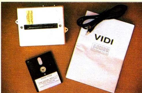
Hasta el momento es el único digitalizador de imágenes de vídeo existente para el PCW. Permite grabar en tiempo real, siendo posible el ajustamiento del brillo y el contraste mientras se esta efectuando el proceso. Las imágenes tomadas pueden ser convertidas a los formatos gráficos más extendidos en el PCW como puede ser Desktop Publisher.
