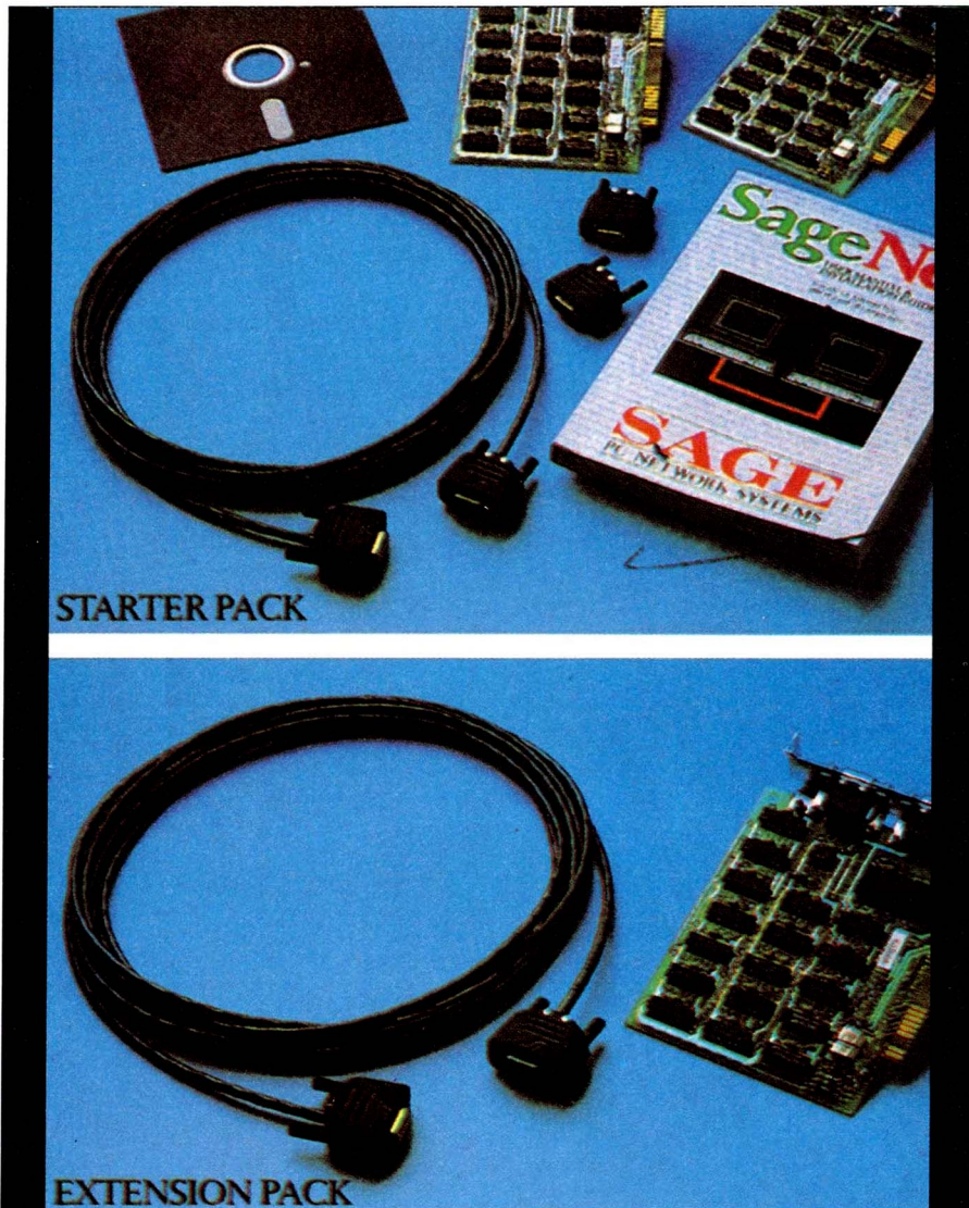
A rede SAGENET utiliza uma topologia BUS, admite um comprimento de até 200 metros e a velocidade nominal de transmissão é de 1 Megabit/segundo.
